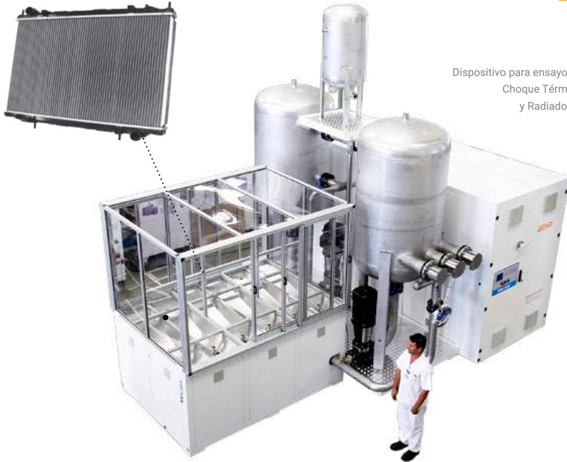
Dispositivo para ensayo de Choque Térmico y Radiadores
