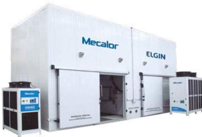
Calorímetro para pruebas de eficiencia energética
