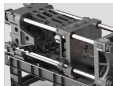
智能开合模 更简便的操作、更加精准的重复定位精度，更快的干周期
